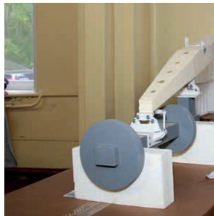
Макет конструктивно подобной модели пилона двигателя МС-21 для исследования эффектов аэроупругости. Макет изготовлен по технологии быстрого прототипирования.
